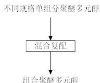
图 3.5-2 组合聚醚多元醇生产流程及产污环节图
